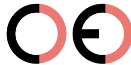
Faux marquage CE (trop éloignée)
